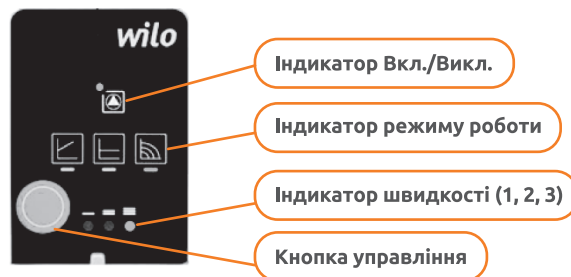
Малюнок 7 – Панель управління насосом Wilo PARA.
