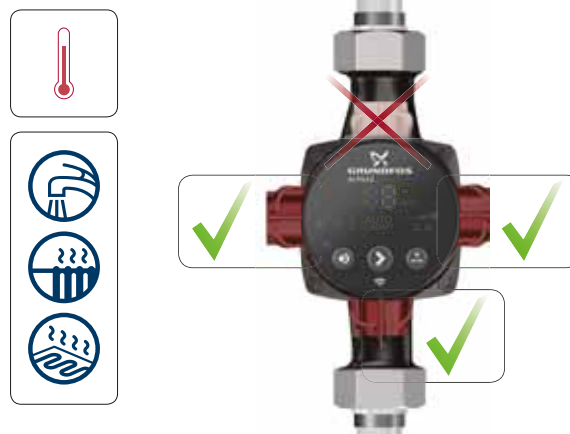
Рис. 3 Положення блока керування, системи опалення та побутові системи гарячого водопостачання
