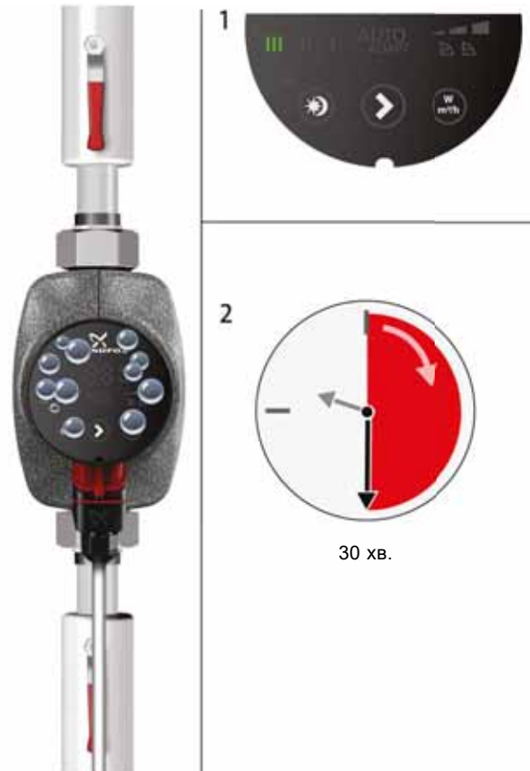
Рис. 8 Видалення повітря з насоса
