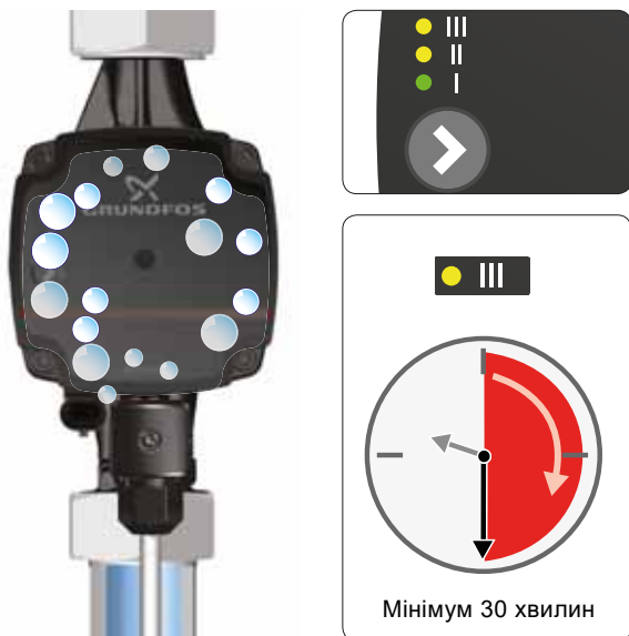
Рис. 7 Видалення повітря з насоса
