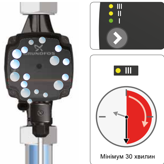
Рис. 7 Видалення повітря з насоса
