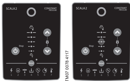
Рис. 19 Установленное значение, заданное пользователем (слева) и определенное автоматически (справа)
