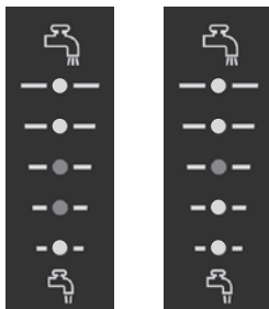
Рис. 14 Индикация давления нагнетания SCALA2
