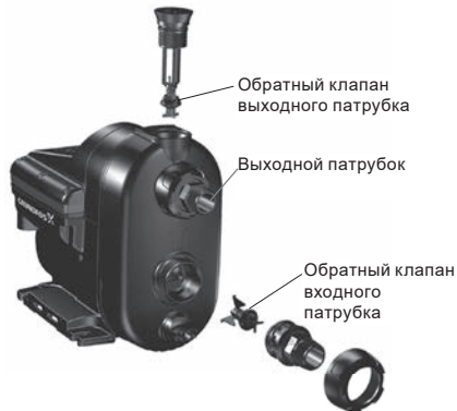
Рис. 23 Обратные клапаны входного и выходного патрубков
