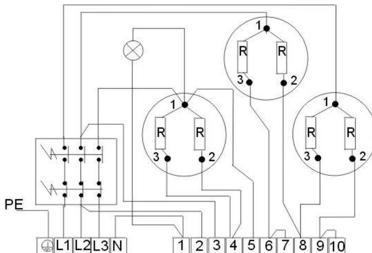
3 кВТ 1 PE - N AC 230 В/50 Гц
